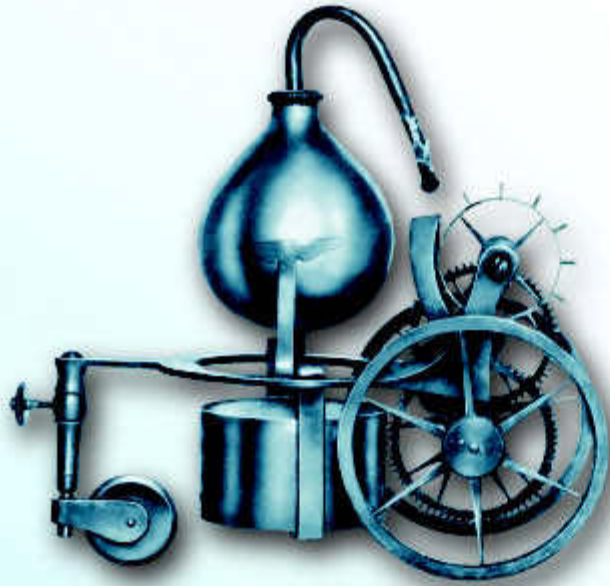
Das erste funktionsfähige Modell eines Dampfwagens nach der Beschreibung von Ferdinand Verbiest, 1678.
