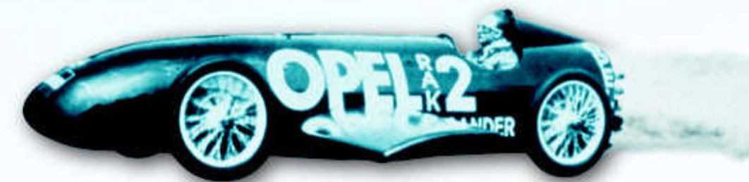
Rasante Antriebs-Alternative: Der RAK II Raketenwagen von Opel ging am 23. Mai 1928 auf der Berliner AVUS an den Startplatz. 24 Pulverraketen beschleunigten das Feuermöster auf etwa 230 Kilometer pro Stunde.
