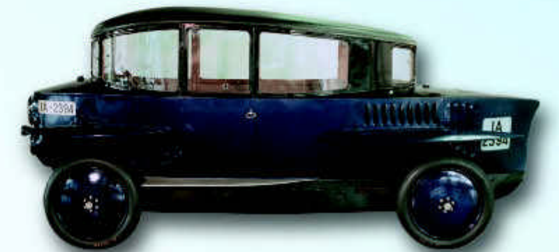
Rumberg-Tropfenwagen – das erste Stromlinienauto. Präsentiert im Herbst 1921 auf der Deutschen Automobilausstellung in Berlin. Von oben gesehen entsprach die Form einem fallenden Wassertropfen. Das sollte den Luftwiderstand mindern und die Staubentwicklung reduzieren. Tatsächlich weist der Wagen mit einem cw-Wert von 0,28 einen niedrigeren Luftwiderstand auf als viele Autos, die ein halbes Jahrhundert später gebaut wurden.
